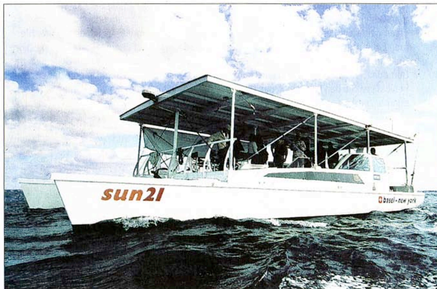
Der Baldachin der «Sun 21» ist mit 48 Solarmodulen bestückt.
